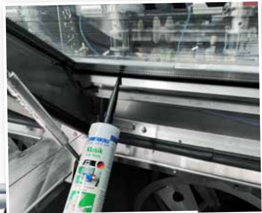
Kleben und dichten einer Glasabdeckung (Olivenverarbeitungsmaschine) | Flex 310 M® Classic
