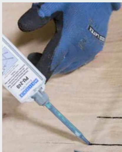
Reparatur an einem Schlauchboot GMK 2410
