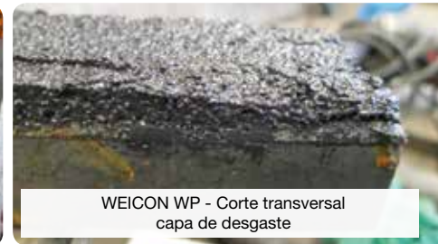
WEICON WP - Reparación y protección contra la abrasión en un molino rampa
