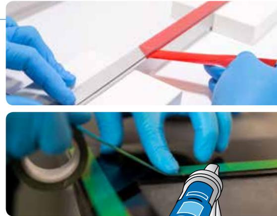
**i** Fixierhilfe in Kombination mit WEICON Kleb- und Dichtstoffen
