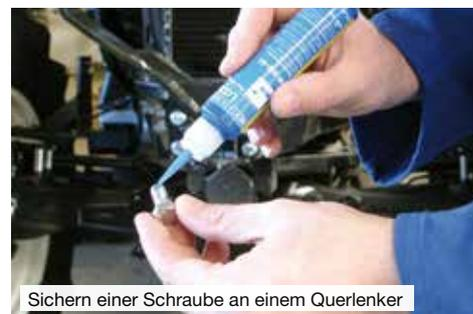
Sichern einer Schraube an einem Querlenker
