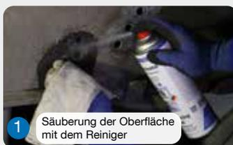
1 Säuberung der Oberfläche mit dem Reiniger
