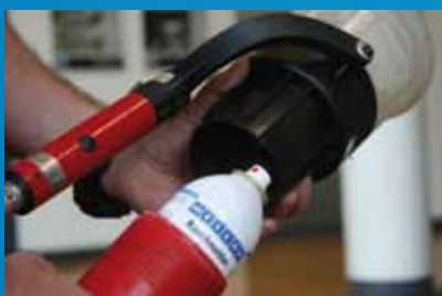
RMTS wird in die Pflückstange montiert.
