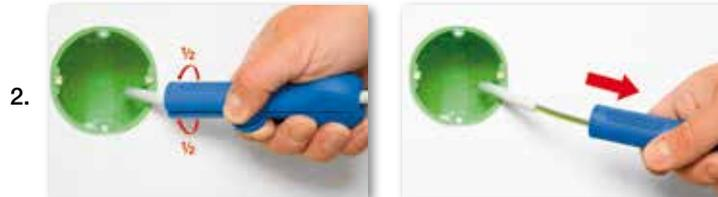
Für die Coaxial- bzw. Antennenkabel wie auch für flexible Kabel ist der Coax-Stripper No. 2 das geeignete Werkzeug. Eine Einstellung der Schnitttiefe ist nicht erforderlich, da das Werkzeug für alle gängigen Coaxialkabel optimiert wurde. (3.)
