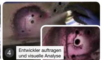
Reiniger, Diffusionsmittel und Entwickler für die zerstörungsfreie Werkstoffprüfung mittels Farbeindringverfahren
