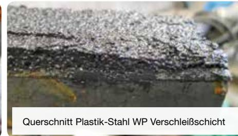
Querschnitt Plastik-Stahl WP Verschleißschicht
