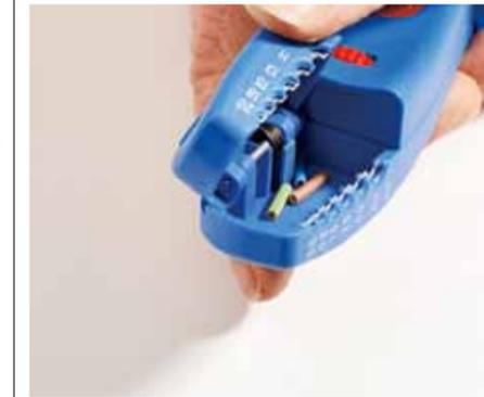
**+ AUFNAHME:** Im Multi-Modell von Weicon werden die Isolationen gesammelt.
