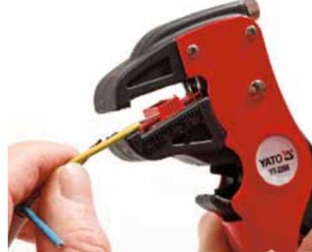
**DRÜCKER:** An der verbleibenden Isolation hinterlässt der Yato Druckspuren.
