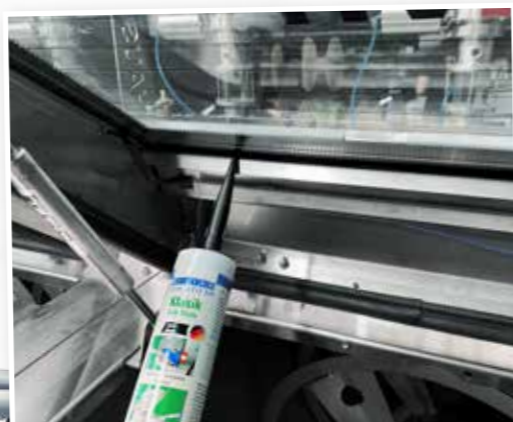
Coller et étancher un couvercle en verre (machine de transformation des olives) Flex 310 M® Classic
