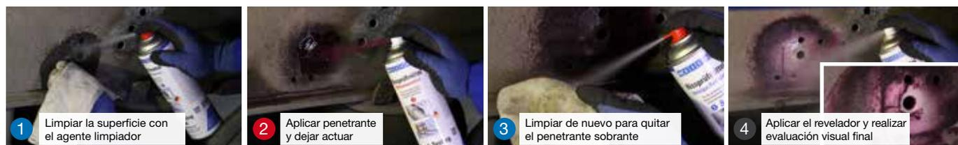
Sistema de detección de grietas para la inspección no destructiva de materiales mediante colorantes penetrantes
