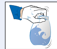
Reparaturband in sauberes Wasser eintauchen
