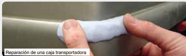
Reparación de una caja transportadora
